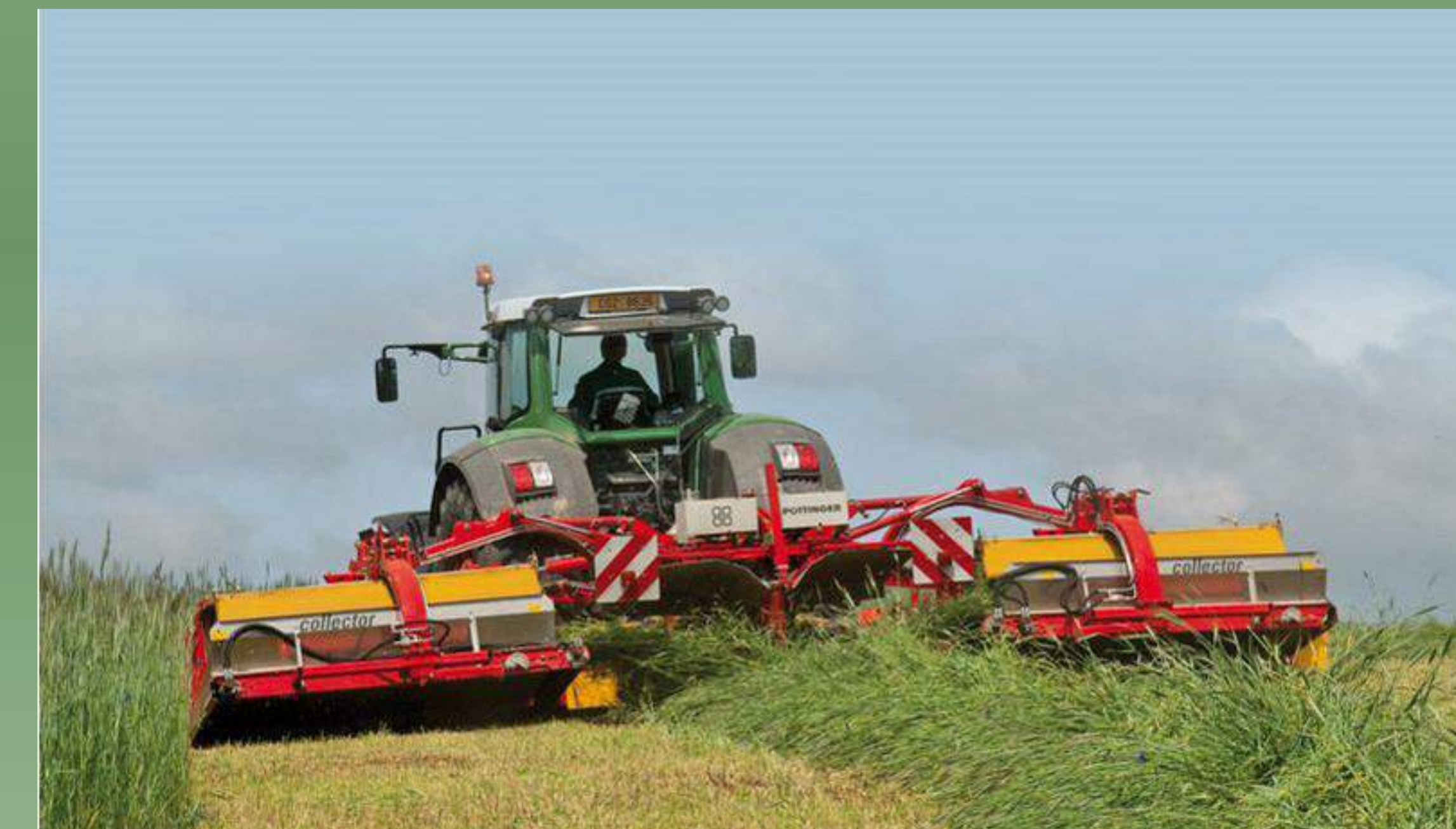
Absetziges Verfahren: Mahd mit Schwadableger
