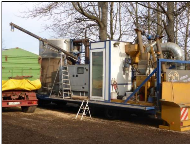
Thermische Behandlung von Körnerleguminosen TLD – Thüringer Landdienste GmbH , mobile Toastanlage
