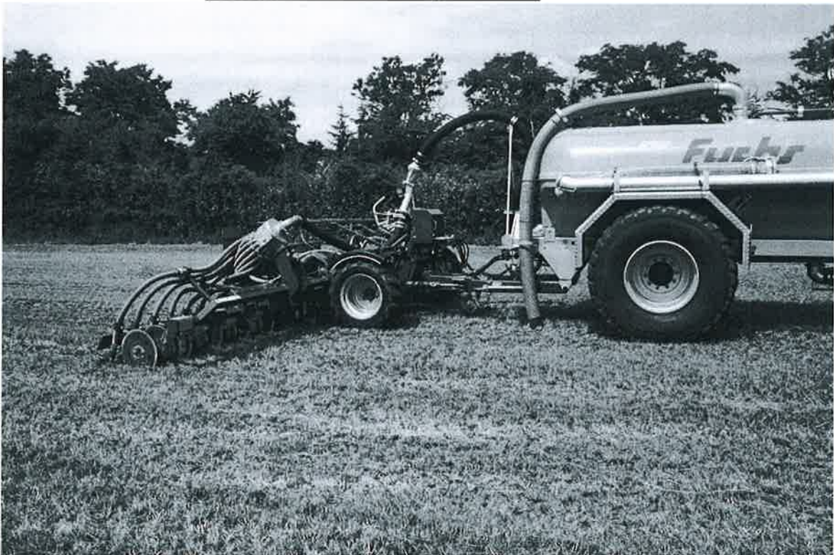
Abb 1+2, aufgesattelte Gülle-Schlitztechnik im Einsatz, Fotos Fa. Graml, www.landtechnik-graml.de
