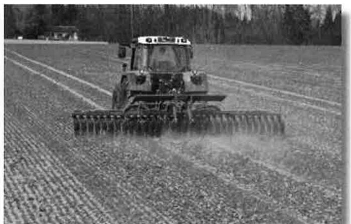
Rotorhacke im Heck ermöglicht vollflächiges Krustenbrechen
