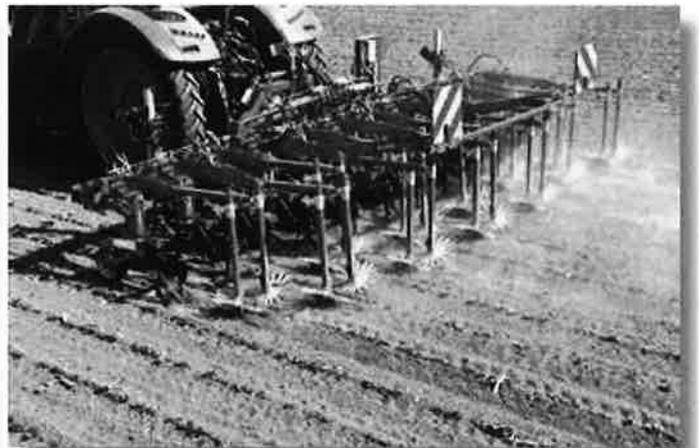
Hacken im Heck mit Kameraleitung und Section-Control Elementaushub über GPS
