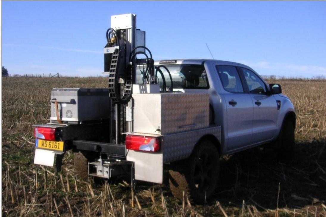
**Bild 8: Bodenprobenstecher (bis 60 cm Tiefe) und Kühlbox auf einen Ford Ranger Geländewagen von J-Reiff montiert.**
