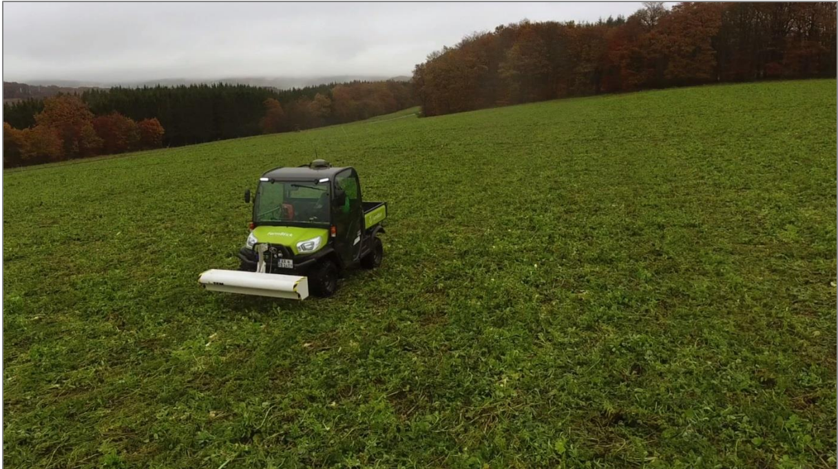
Abbildung 21: Bodenscanner von FarmBlick zur Messung der Leitfähigkeit des Bodens. Quelle: FarmBlick
