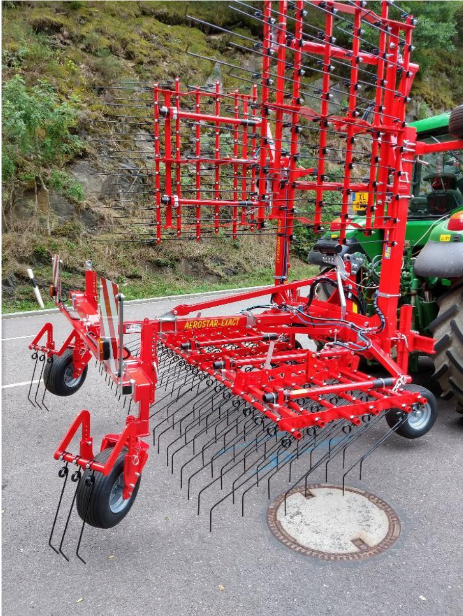
Bild 9: Exaktstriegel der Firma Einböck, der im Herbst 2019 von der LAKU angeboten wurde
