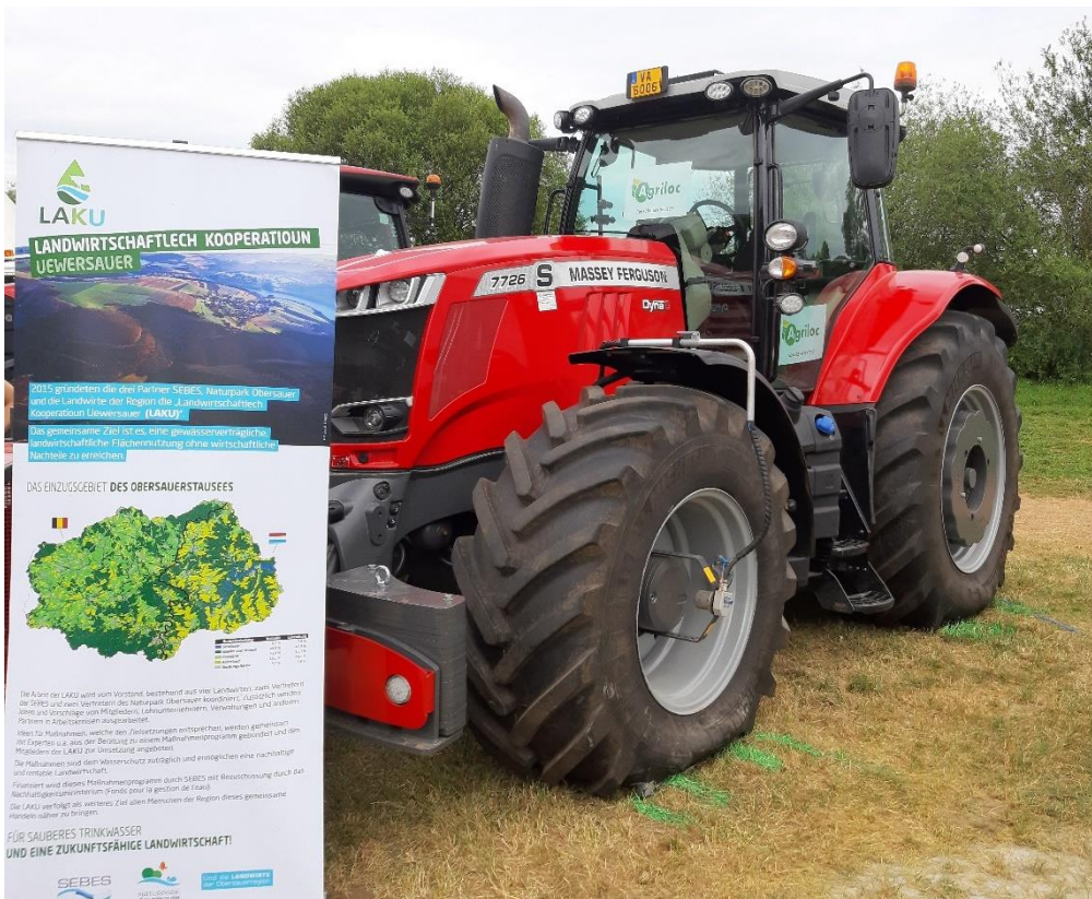
Bild 2: Traktor mit Reifendruckregelanlage auf dem Stand der LAKU auf der Foire Agricole 2019 in Ettelbrück. Deutlich zu sehen sind die Einbuchtungen in den Reifen durch den reduzierten, d.h. bodenschonenden Reifendruck. Foto: LAKU
