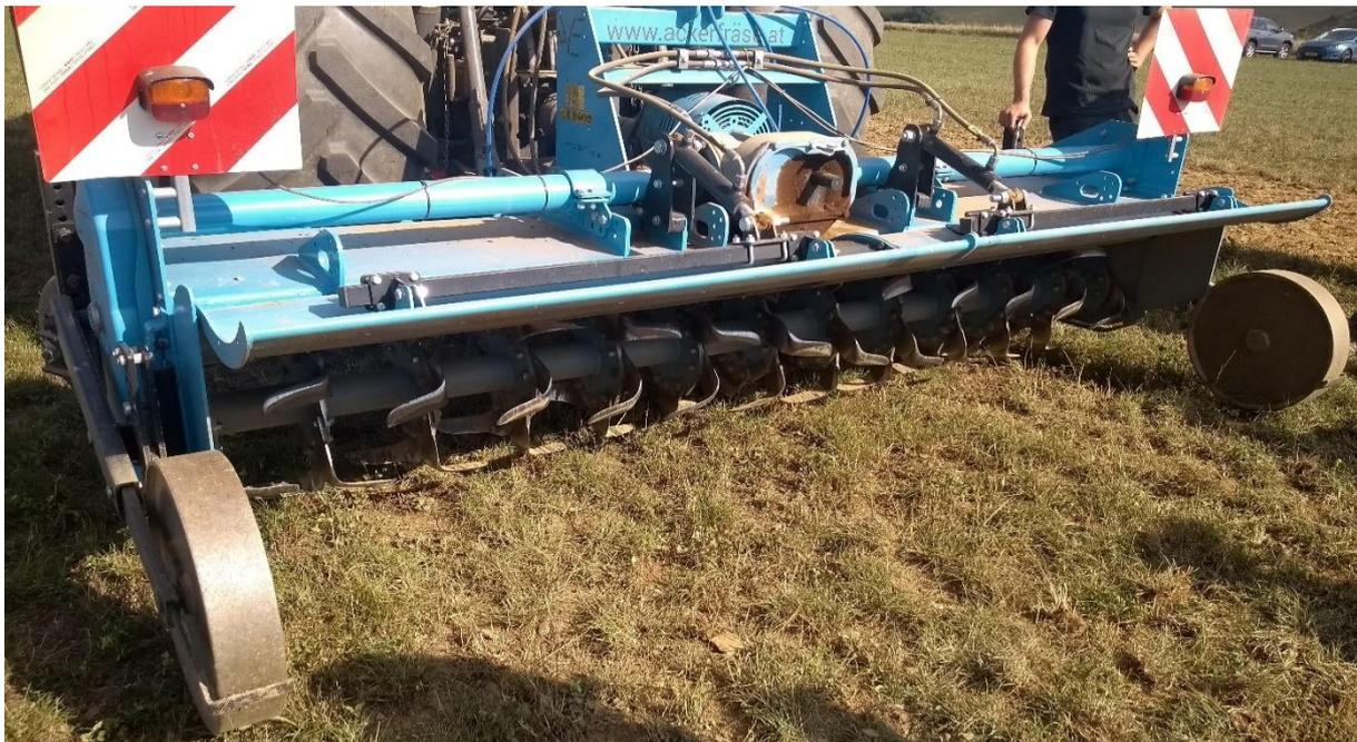
Bild 10: Schälmaschine von Vortex, die 2020 zum Umbruch von Zwischenfurchten und speziell Feldfutter eingeführt wurde. Dazu kann ein Rottelenker mit ausgebracht werden, der den Boden verbessern und den Unkrautdruck verringern soll.
