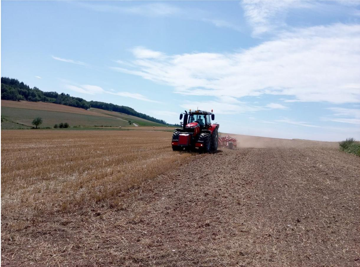
**Bild 1:** Aussaat der Zwischenfrucht am 20.08.20 mit dem Flachgrubber. Jenseits des linken Rands der Grubber-Arbeitsbreite die unbearbeitete Stoppel und die zum Zeitpunkt noch nicht aufgelaufene Vorerntesaat.
