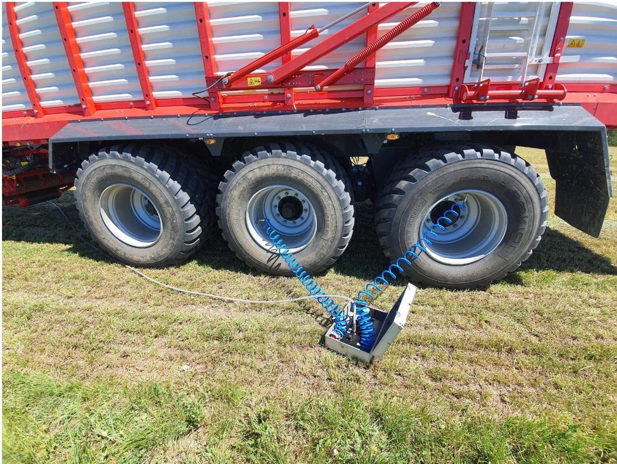
Bild 7: Mobile Reifendruckregelanlage mit Kompressor im Einsatz zum Absenken des Reifendrucks
