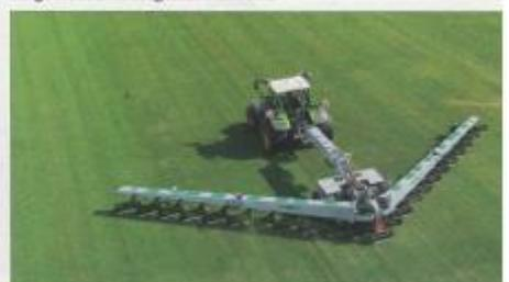
Die V-MOW, ein vom Betrieb Rollrasen Van de Sluis entwickeltes Mähwerk, um das Gras möglichst schonend zu schneiden und zu
