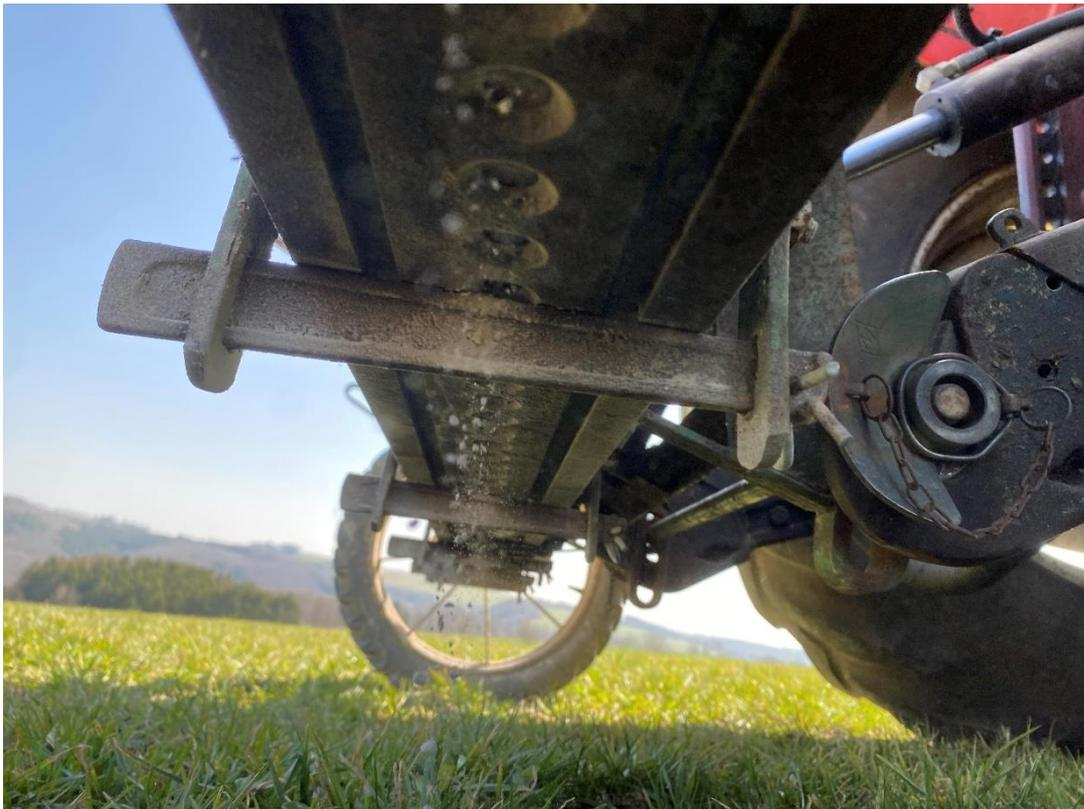
Abbildung 1: Untere Ansicht des Kastenstreuers mit Lochscheibe.
