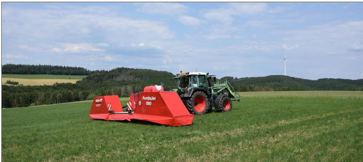
Diese Daten zeigen, dass der tatsächliche Verbrauch durch den RumboJet 880 und die selektive Pflanzenschutzmittelausbringung auf allen Applikationsflächen deutlich unter der üblichen Aufwandmenge lag. Diese Einsparung je nach Mittel von 92 – 95 % entspricht durchaus den Angaben des Herstellers, welche eine Reduzierung des Herbizideinsatzes von ca. 80% bis zu 98%, natürlich je nach Ampferbesatz, ermöglicht.
